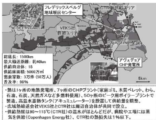
図16 コペンハーゲン広域の熱供給システム
