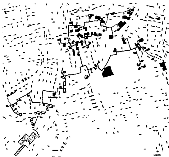
図2 オーストリア・Dornbirnのバイオマス地域熱供給 (バイオマスボイラー1800kW、導管延長5.5km、97棟接続)
