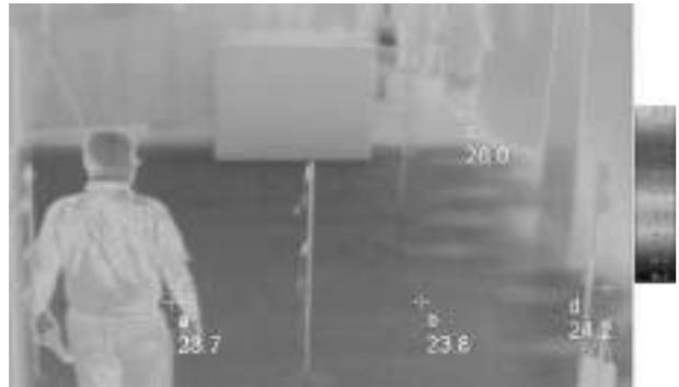
図17 床冷房状況 (熱画像)
