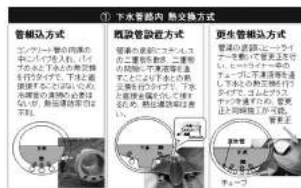
図2 海外における下水熱交換方式の事例
