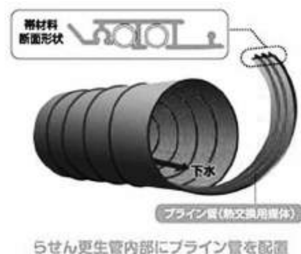
図7 集熱器組込型更生管
