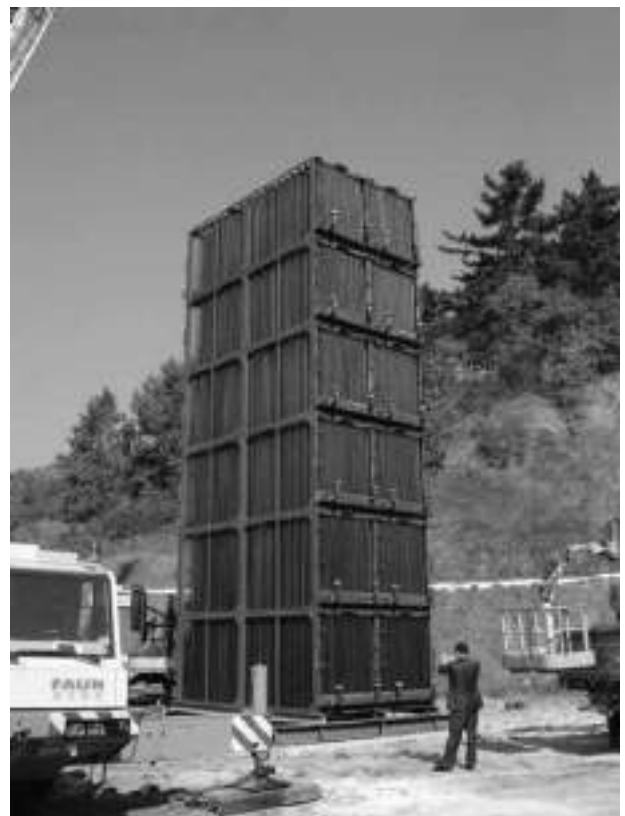
図－5 自社製氷蓄熱コイル積み上げ試験（6段高さ12m）
