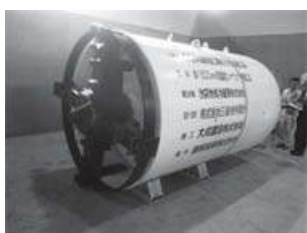
図9 G1～G2 立坑間用推進掘削機
