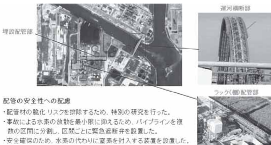
写真2 水素パイプラインの敷設状況
