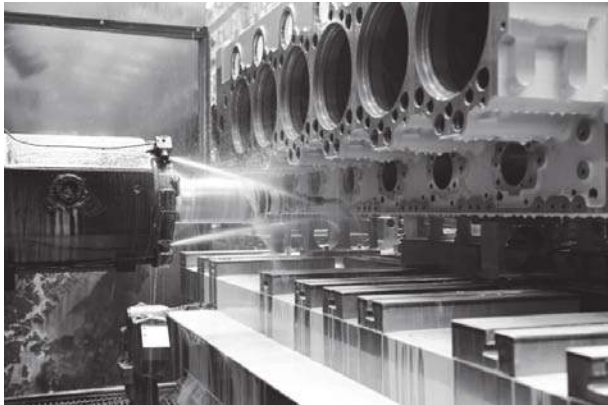
写真3 シリンダブロック加工
