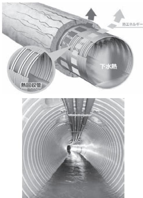
図7 管更生一体タイプ（引用：積水化学工業HP）
