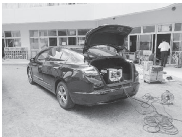
図5 保育所で停電があった際に燃料電池自動車から電気を取り出している様子
