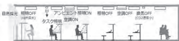
図10 画像センサによる空調・照明制御
