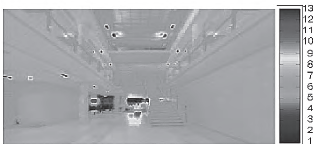
図8 アトリウムにおける明るさ感:NB値（竣工後実測）
