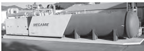
図7 1 MW級SOFC発電システム（ハーフ出力実証機）
