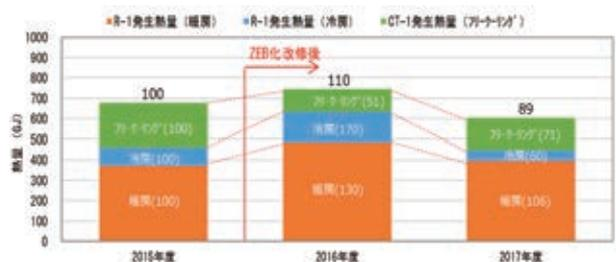
図22 年間冷房、暖房、フリークーリング供給量の比較
