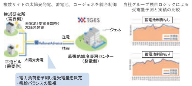
図5 分散型エネルギーリソースの統合制御
