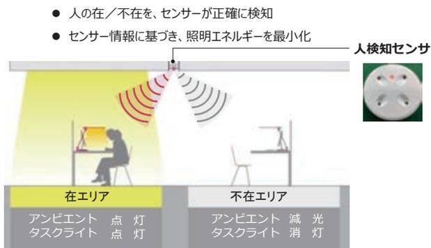
図15 次世代人検知システム T-Zone Saver
