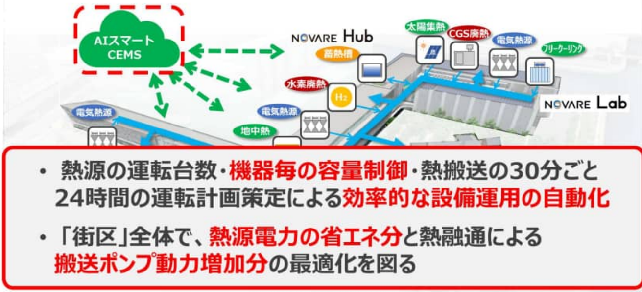
NOVAREにおける双方向熱融通
