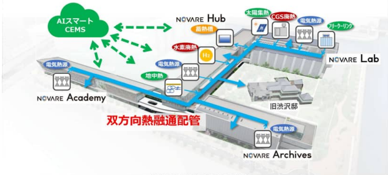
NOVAREにおける双方向熱融通
